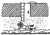
マンホール内に硫化水素滞留
