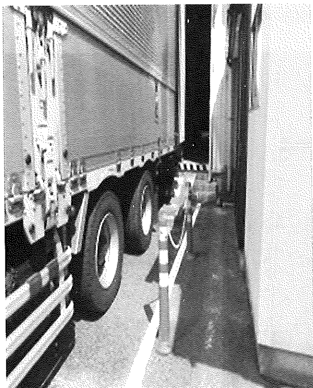
トラックの出入りが多い事務所前の安全通路に白線だけではなく、ポールとくさを設置して接触防止を図っている。
